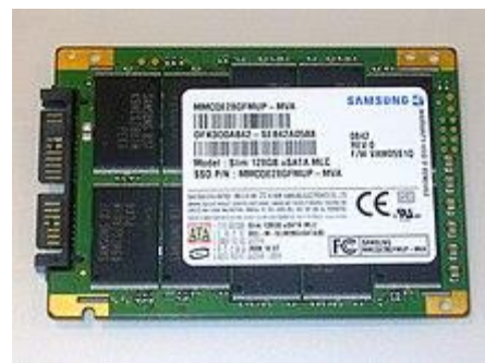
Рис. 1 в накопичувачі SSD немає рухомих частин
